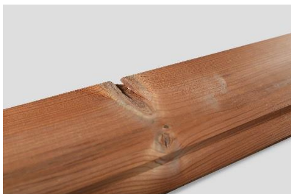
Duże pęknięcie sęka.
